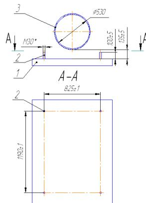
Рисунок 2. Схема площадки для установки ПГС
