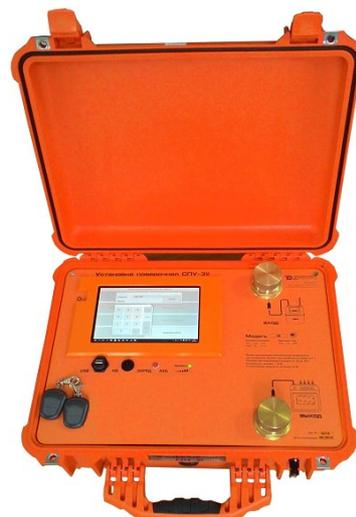
Рисунок 2 – Общий вид установок поверочных СПУ-3М со встроенным показывающим и управляющим устройством без принтера
