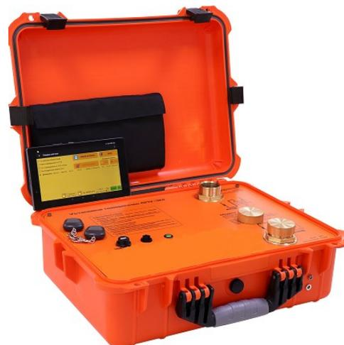
Рисунок 4 – Общий вид установок поверочных СПУ-3М с внешним показывающим и управляющим устройством без принтера
