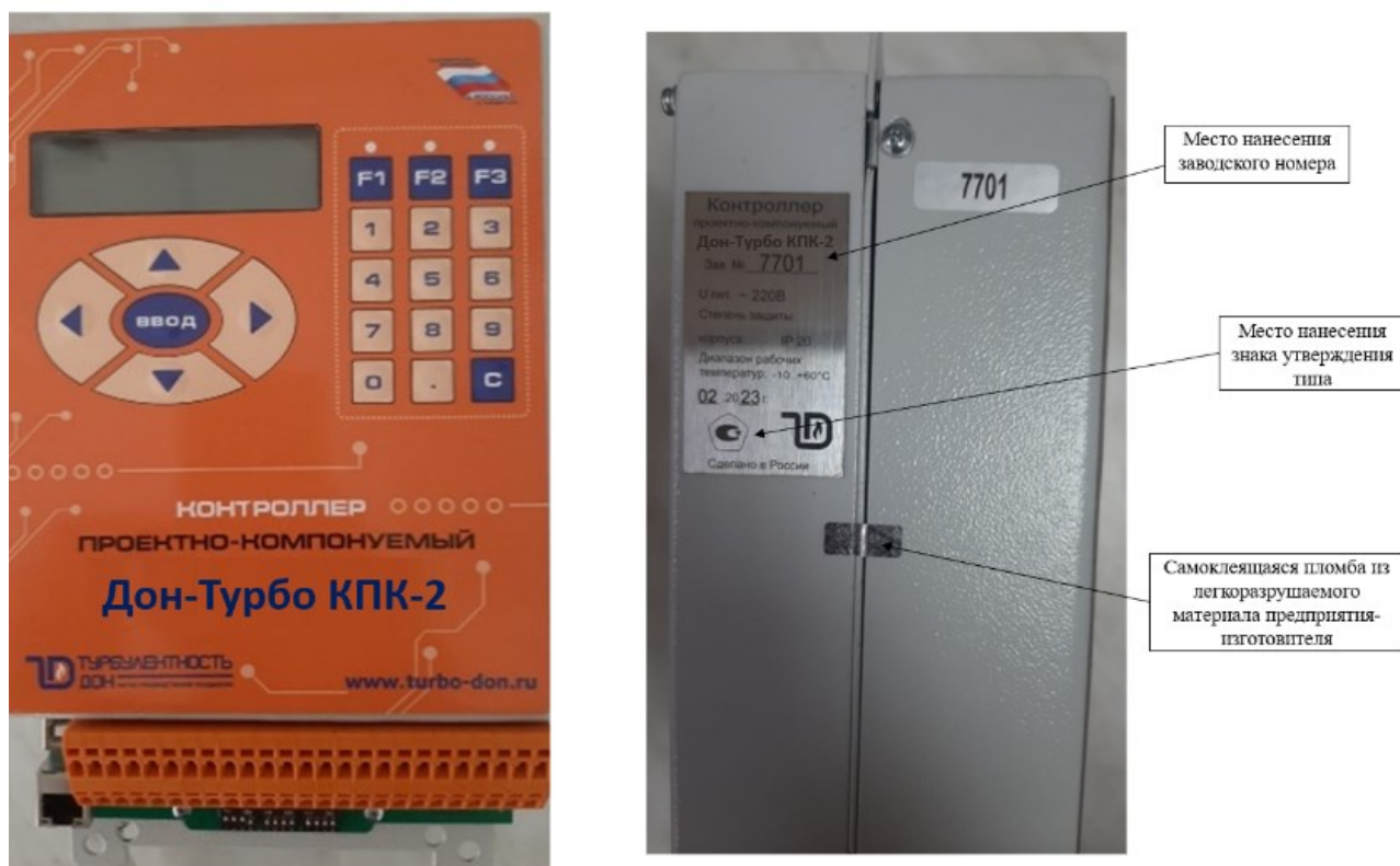
Рисунок 3 – Общий вид контроллеров в исполнении корпуса КПК-2 с указанием места нанесения заводского номера, места нанесения знака утверждения типа и мест пломбировки
