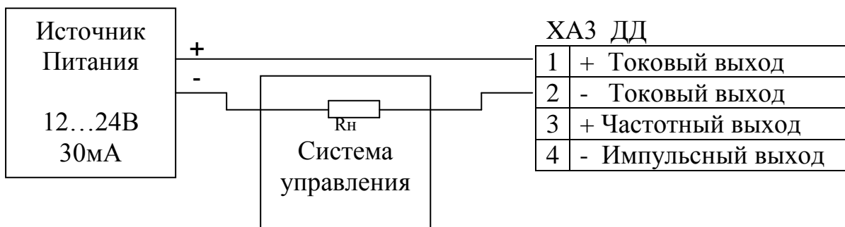
Рисунок Г.1 – Схема подключения датчика с токовым выходом 4-20 мА с питанием от токовой петли либо автономного источника.
