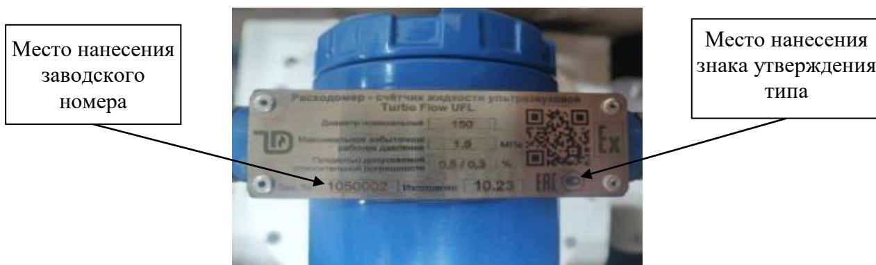
Рисунок 6 – Маркировочная табличка расходомеров – счетчиков Turbo Flow UFL
